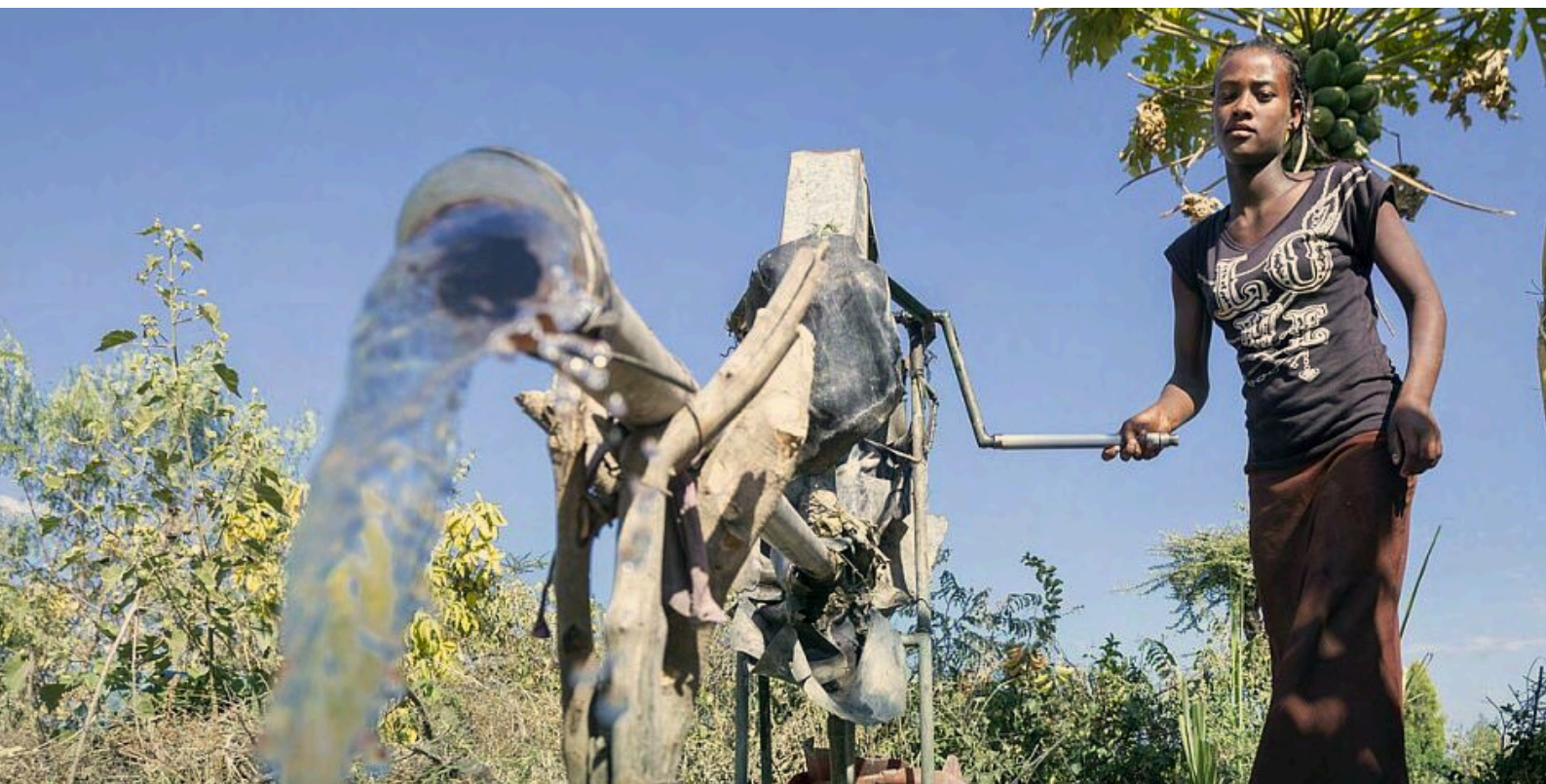
Utilisation d'une pompe à corde pour puiser de l'eau. © Petterik Wiggers/IWMI
