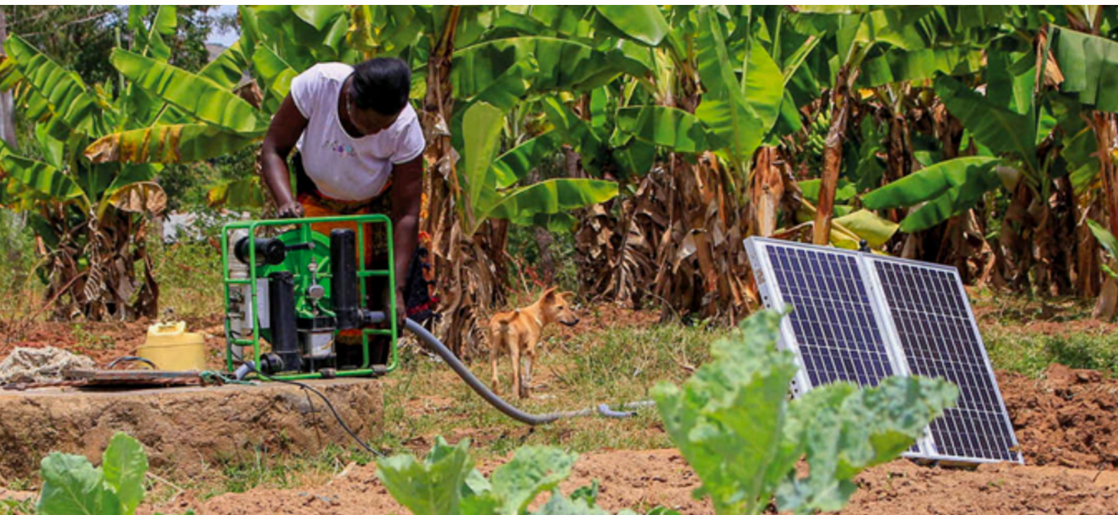
Agriculteur utilisant une pompe d'irrigation solaire avec capteur © Futurepump.
